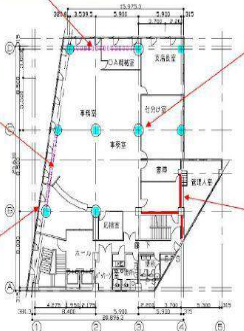
基準階平面図 (改修後) ● 耐震補強柱 ■ 制振ブレース ■ 鋼板パネル壁
